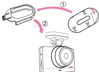
2 전방 블랙박스는 운전자의 시야를 가리지 않는 위치를 선정하여 전면(예. 전면 룸미러 앞)에 부착하며, 후방 카메라도 운전에 방해되지 않는 위치에 부착하여 주시기 바랍니다.
