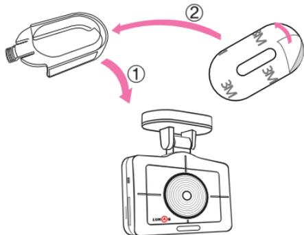
2 전방 블랙박스는 운전자의 시야를 가리지 않는 위치를 선정하여 전면 (예, 전면 룸미러 앞에 부착하며, 후방 카메라도 운전이 방해되지 않는 위치에 부착하여 주시기 바랍니다.
