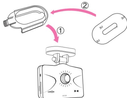
2 전방 블랙박스는 운전자의 시야를 가리지 않는 위치를 선정하여 전면 (예, 전면 룸미러 앞)에 부착하며, 후방 카메라도 운전에 방해되지 않는 위치에 부착하여 주시기 바랍니다.
